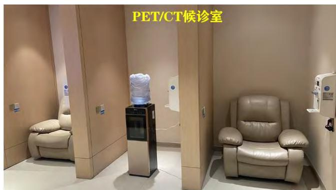
PET/CT 候诊室内设 2 人候诊位(场所建设时，在 PET/CT 候诊室共设了 3 个候诊位。按照批复要求，目前 1 个位置放置饮水机，其它 2 人位置用于患者候诊。候诊位之间隔断为 6mm 到顶的铅屏蔽隔断。)
