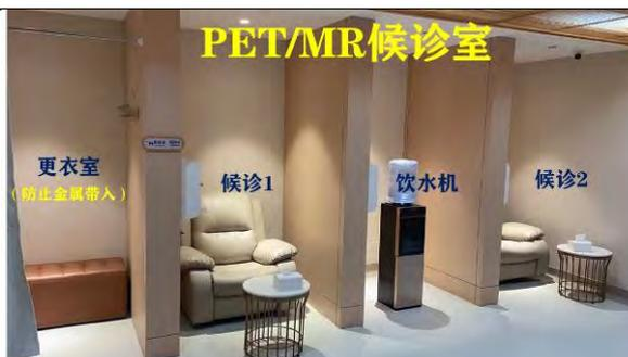
PET/MR 候诊室内设 2 人候诊位(场所建设时，在 PET/MR 候诊室共设了 4 个候诊位。按照批复要求，目前 1 个位置放置了饮水机，1 个位置为 PET/MR 检查更衣区，其它 2 个位置用于患者候诊。候诊位之间隔断为 6mm 到顶的铅屏蔽隔断。)
