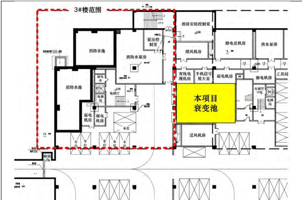
图 10-3 地下一层平面布局以及衰变池位置示意图
