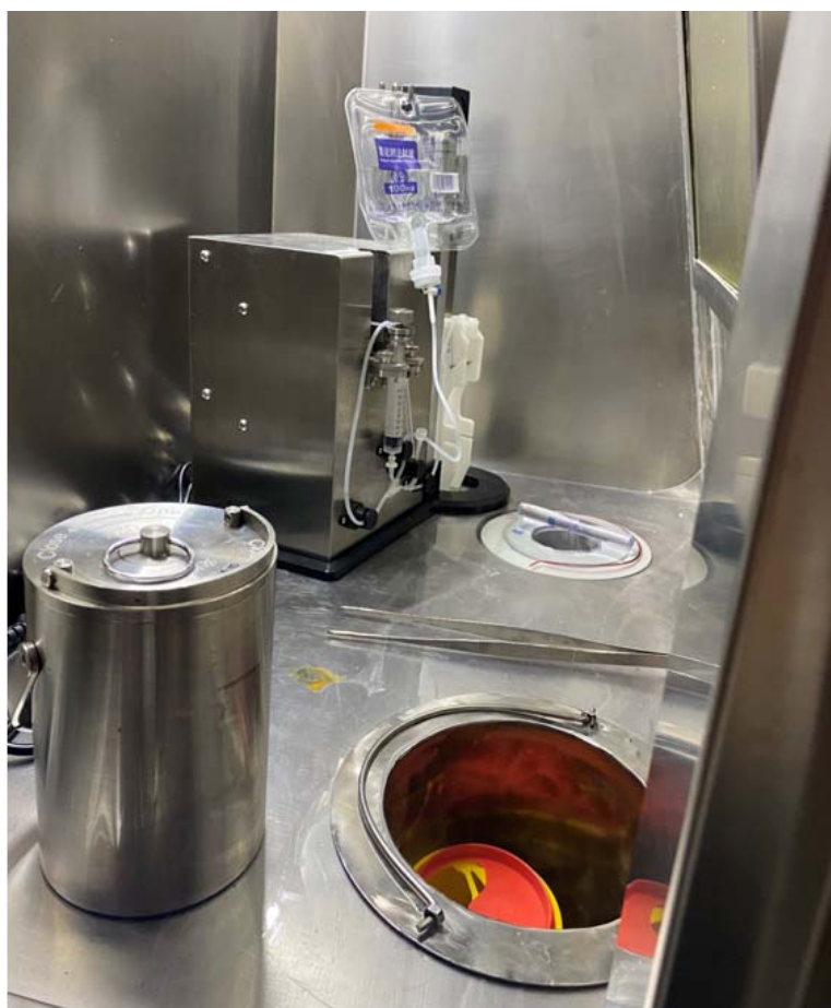
通风橱内药物分装铅罐和不锈钢台面
