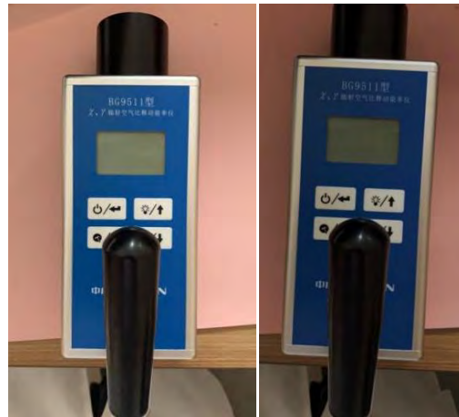
辐射巡检仪 2 台
