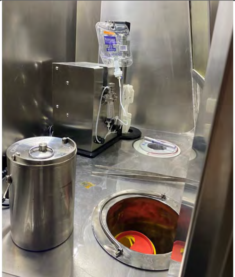
通风橱内药物分装铅罐和不锈钢台面
